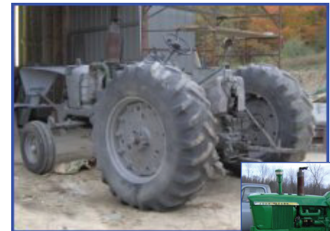
Tractor Sandblasted, ready for primer
