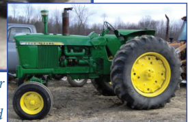
Tractor Sandblasted, ready for primer
